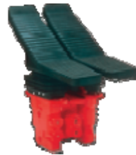
Fig. 4.85. Variante constructive de distribuitoare pilot.
