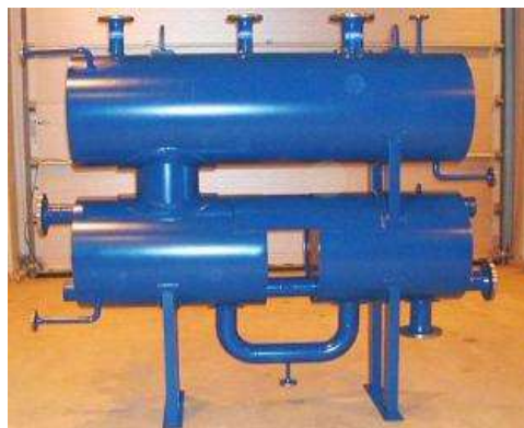
Fig.3.50 - Grup economizor-vaporizator –separator de
