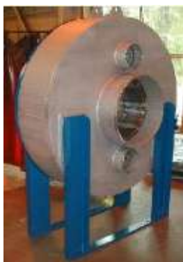
Fig.3.47 - Recuperator de căldură din gaze evacuate
