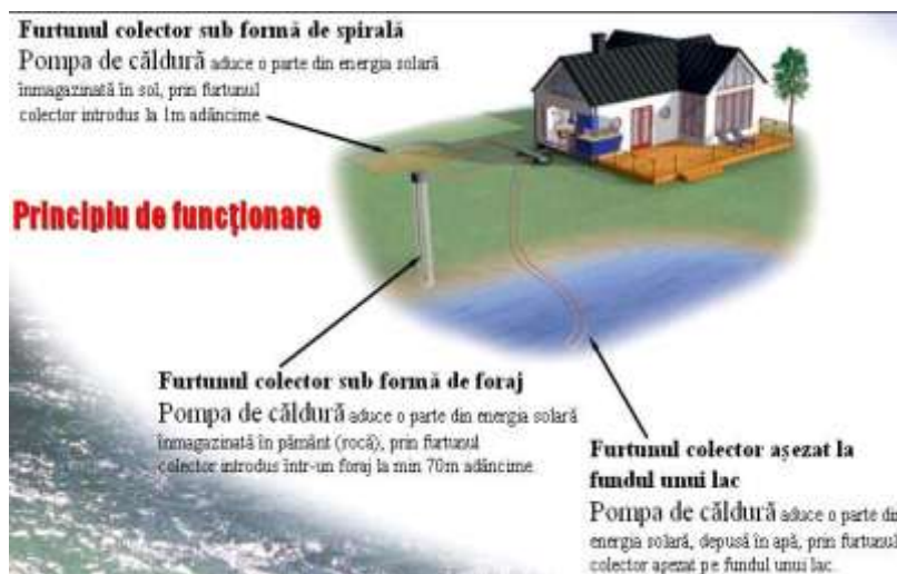
Fig.4.2 - Principul de funcționare a pompelor de căldură de tip sol și apă [2]
