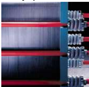
Fig.3.22 – Strângerea laterală suplimentară cu tiranți și arcuri la schimbătoarele cu plăci din grafit sau materiale compozite [30]
