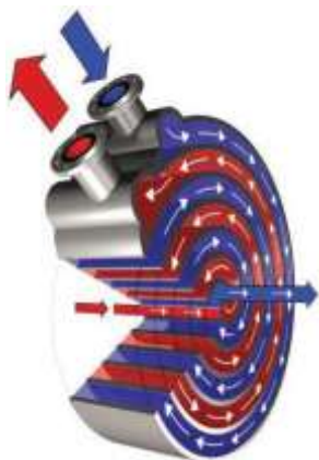
Fig.3.75 – Principiul de funcționare a unui schimbător spiralat [35]
